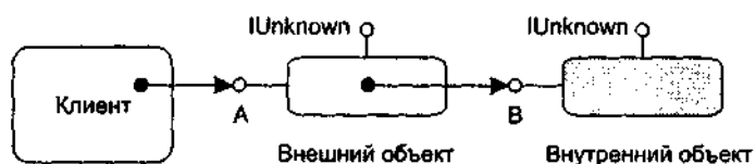
Рисунок 8 - Повторне використання Com-Об'єкта за допомогою включення
