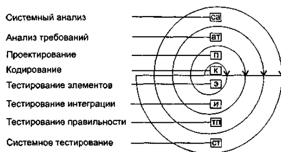
Рисунок 1 - Спіраль процесу тестування ПС
