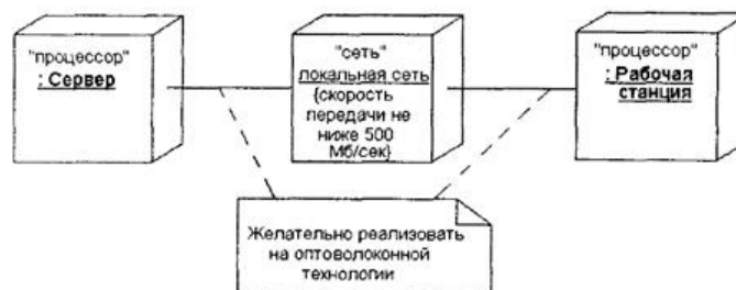
Рисунок 4 - Фрагмент діаграми розгортання із з'єднаннями меходу вузлами
