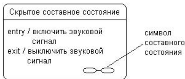
Рисунок 4 - Складений стан зі схованою внутрішньою структурою й спеціальною піктограмою
