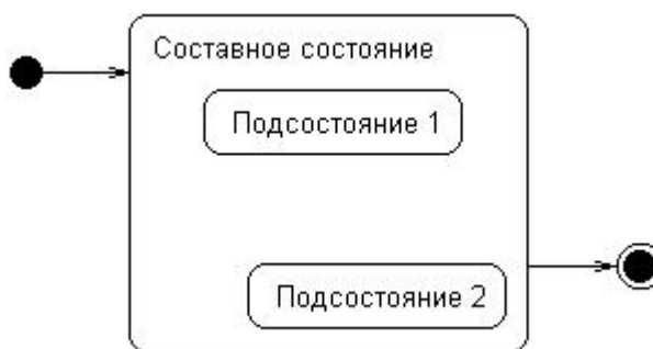
Рисунок 1 - Графічна вистава складеного стану із двома вкладеними в нього послідовними подсостояниями
