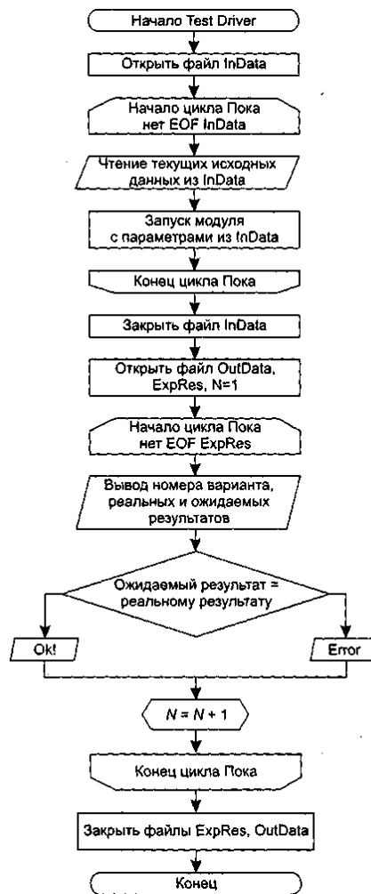
Рисунок 3 - Алгоритм работы драйвера тестування
